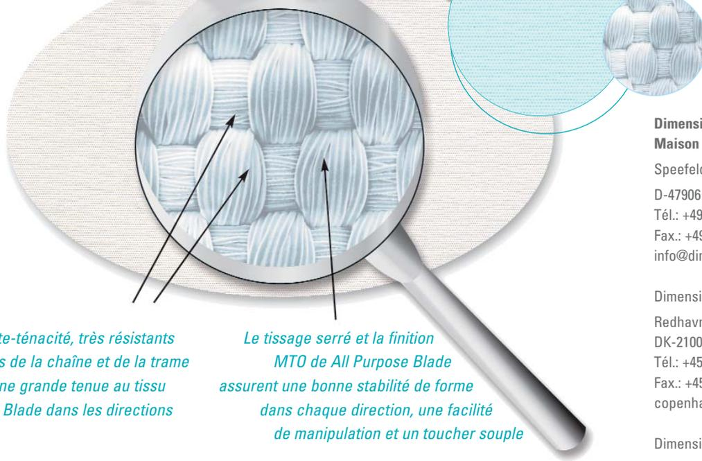
Les fils haute-ténacité, très résistants dans le sens de la chaîne et de la trame confèrent une grande tenue au tissu All Purpose Blade dans les directions principales
